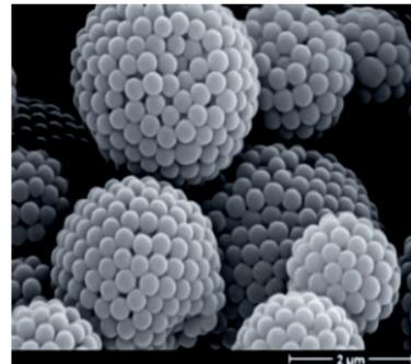
**ABBILDUNG A:** Redispergierbare Silica-partikel als Nanofüllstoffe (Fraunhofer-ISC). Diese Betonzusammensetzungen werden in einigen Anwendungen eingesetzt, eine breite Marktdurchdringung hat sich bislang aber nicht ergeben.
