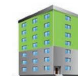
SCHUTZZONE FASSADE Grauer Abschnitt: Schutzzone Sockel (deckt den Schutz im Falle eines Raumbrands mit ab). Grüner Abschnitt: Schutzzone Raumbrand.
