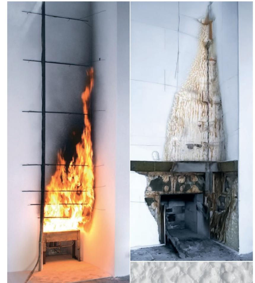
DIE BRANDPRÜFUNG im Originalmaßstab nach E DIN 4102-20 (Bild links) und der Prüfstand nach der Brandprüfung mit entferntem Putz (Bild rechts).
