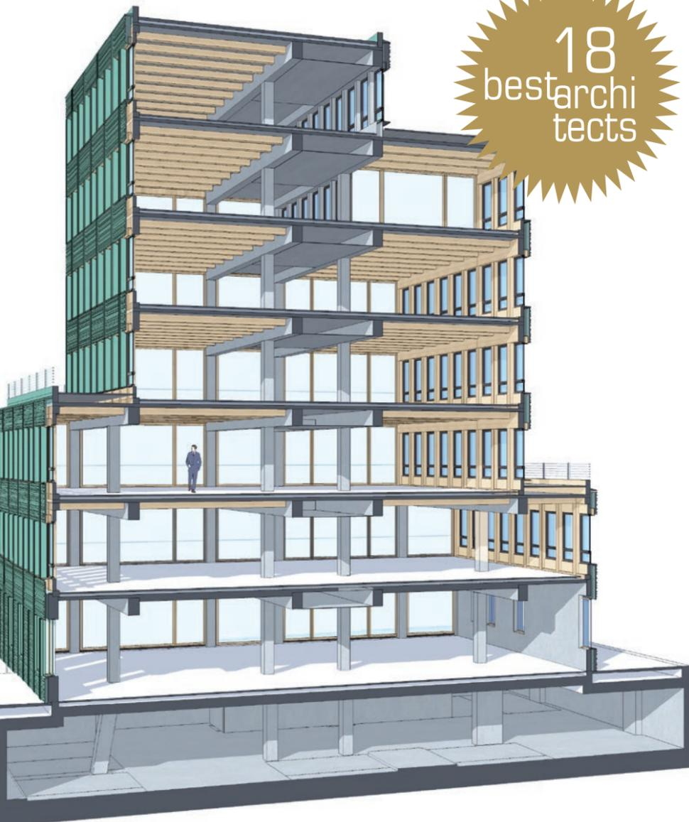
**EINE BESONDERHEIT** liegt in der sichtbaren Verwendung für die tragenden Außenwände und die Holz-Hybrid-Decken. Die Wand- und Deckenelemente sind vorgefertigt worden und oberflächenfertig montiert. Durch die sichtbare Holzoberfläche entsteht im Inneren eine beinahe wohnlich anmutende Atmosphäre.
